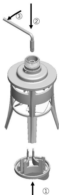
fig. 10. Démontage de l'outil presse-purée (TB013)
