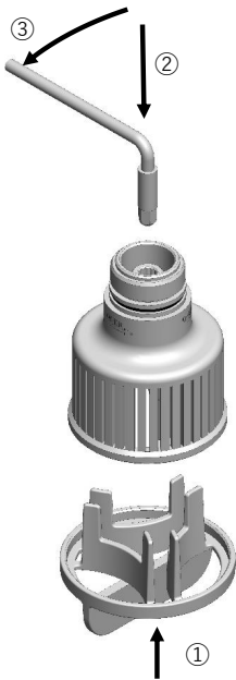
fig. 38. Entfernen des Emulgierwerkzeugs des Turbo-Blenders (TB004)
