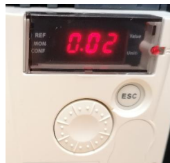
fig. 15. Affichage du temps d'utilisation sur un appareil avec une Alimentation monophasé 230V
