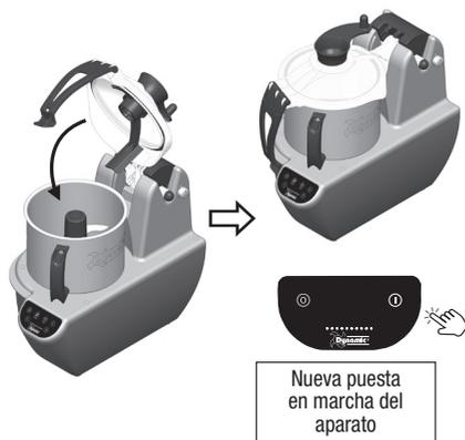
Si los LEDs encima de los botones « 0 » y « 1 » parpadean simultáneamente, verificar que la tapa está bien cerrada, en particular a nivel del cierre.
